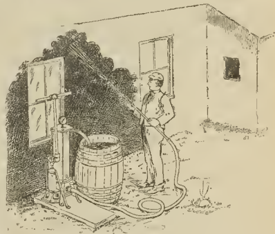
Fig. 3. — Máquina Hook para pintar, modelo «Meilleure»
